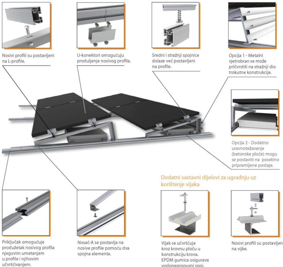
**Slika 3-19 Izvedba montažne konstrukcije na limenim kosim krovovima za Varijantu 2)**
