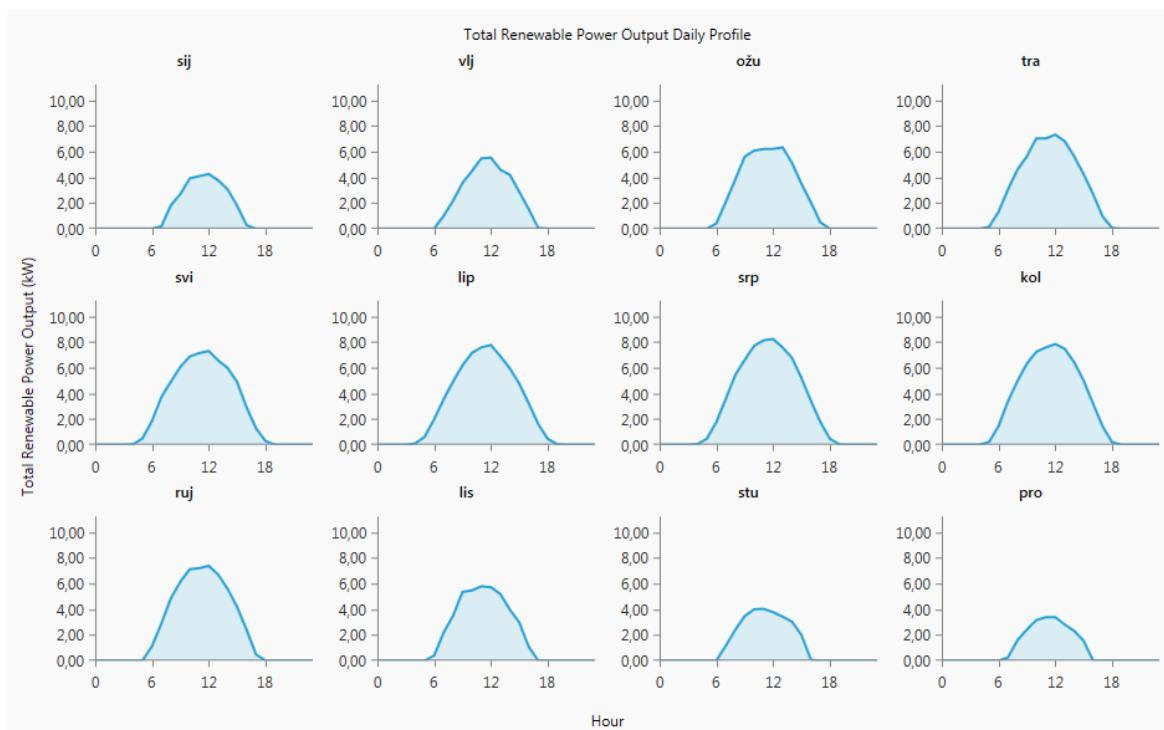
Slika 4-35 Prosječne dnevni profili dostupne snage iz FNE - HOMER
