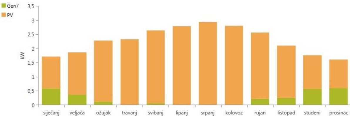
Slika 4-93 Prosječne dnevne angažirane snage i udio proizvodnje dizel generatora – HOMER
