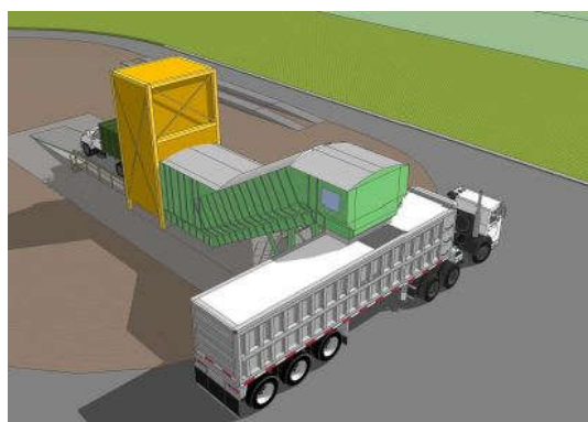
Slika 6. Pogled na pretovarni lijevak.
