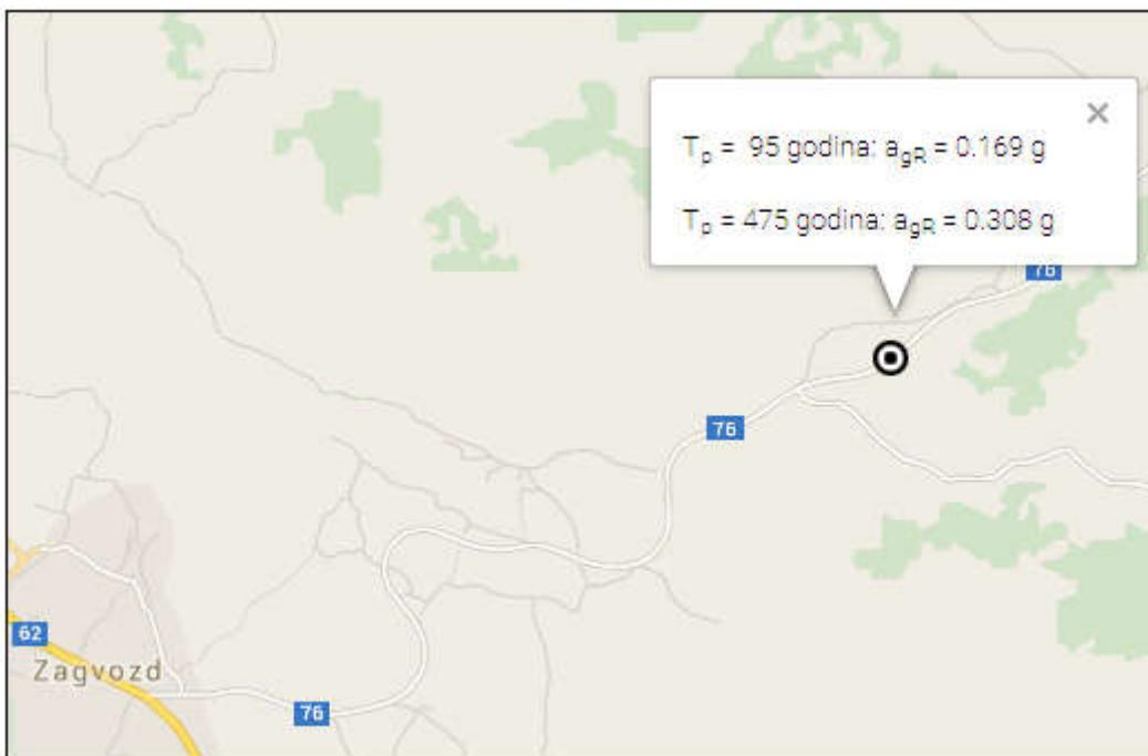
**Slika 13.** Iznos horizontalnih vršnih ubrzanja tla tipa A ( $a_{gR}$ ) za povratna razdoblja od  $T_p=95$  i  $475$  godina, izraženih u jedinicama gravitacijskog ubrzanja ( $1 \text{ g} = 9.81 \text{ m/s}^2$ ), za područje zahvata. Izvor: [www.seizkarta.gfz.hr](http://www.seizkarta.gfz.hr) (travanj, 2015.).
