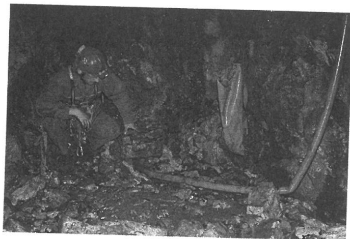
Fot. 2: Upuštanje trasera i vode za ispiranja kroz vatrogasno crijevo
