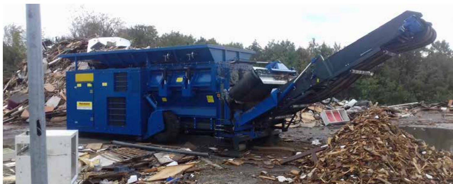
Drveni otpad usitnjava se specijalnim strojevima
