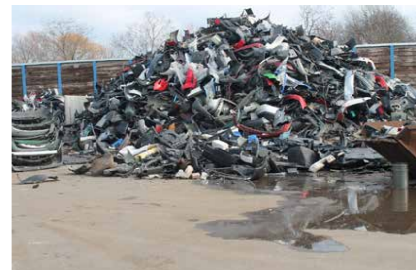
Velike polimerne komponente (branici otpadnih vozila) posebno se izdvajaju i šalju na daljnju obradu u specijalizirane tvrtke za reciklažu polimera.
