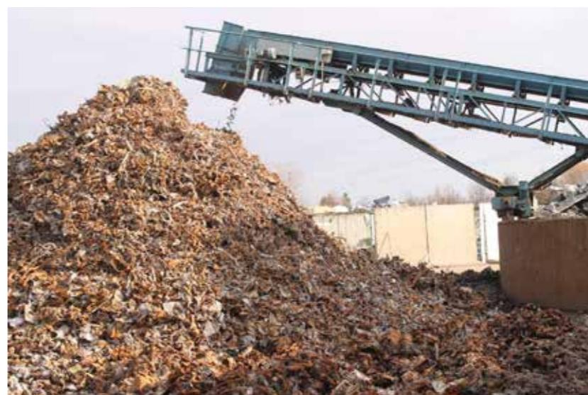
Otprilike 60 % ukupne mase automobila čini čelični lim. Na slici je prikazana završna frakcija lima iz postupka drobljenja. Lim nakon drobljenja odlazi u ljevaonice i željezare kao sekundarna sirovina te se od njega rade poluproizvodi (ingoti).
