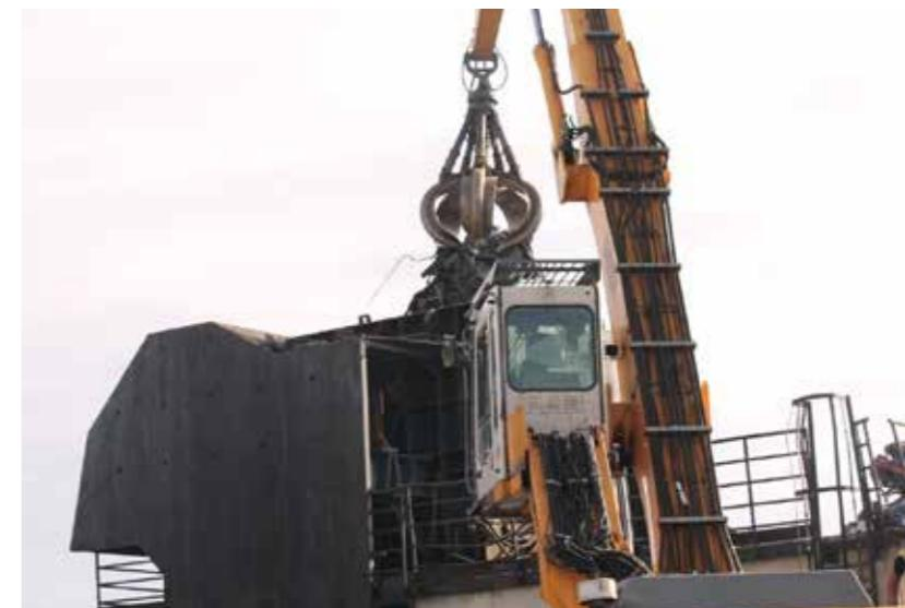
Završna faza mehaničke obrade otpadnog vozila: ostatak karoserije ulazi u mlin za drobljenje (tzv. šreder).
