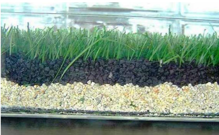
Slika 9: Gumeni granulat – ispuna u umjetnoj travi
