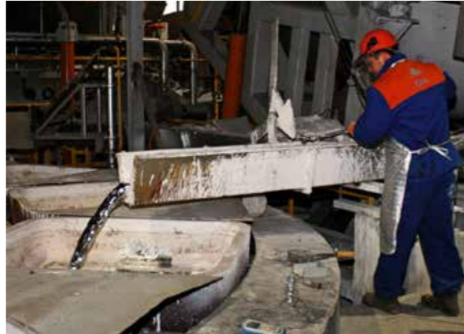
Ispuštanje lijeva iz peći
