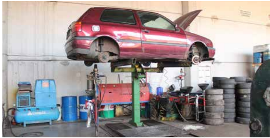
Izrabljeni automobili dopremaju se u centre gdje započinje proces demontaže i pripreme iskoristivih dijelova za daljnju uporabu
