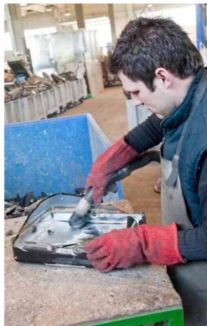
Odstranjanje fosfora s unutarnje stjenke tv ekrana
