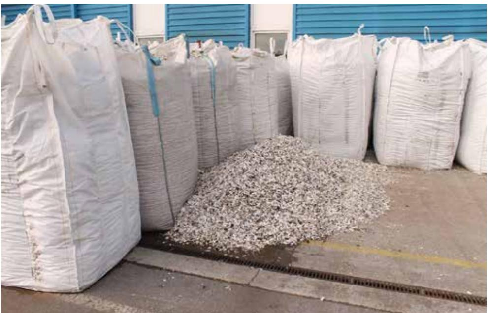
Na liniji za obradu rashladnih uređaja dobiva se tzv. polimerna frakcija. Ona ide na daljnju obradu u specijalizirane tvrtke za proizvodnju komponenti koje se ponovno koriste u proizvodnji novih rashladnih uređaja. Od polimera se proizvode posude unutar hladnjaka, neki vanjski i pokrovni dijelovi te unutrašnja obloga uređaja.
