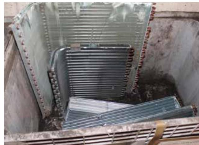
Na slici su prikazani bakreni i aluminijski dijelovi iz rashladnih uređaja koji se koriste kao sekundarna sirovina u tzv. rafinerijama obojenih metala. Upravo su ovi dijelovi razlog zbog kojeg neovlašteni i ilegalni sakupljači uzimaju otpadnu tehniku (hladnjake i klima uređaje). Rastavljanjem ovih uređaja bez adekvatnog alata dolazi do nekontroliranog ispuštanja freona u atmosferu.
