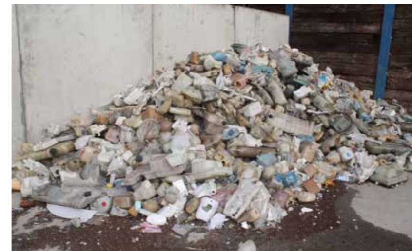
Polimeri (plastični spremnici za tekućine iz otpadnih vozila) se izdvajaju i šalju na daljnju obradu u tvrtke koje proizvode polimerne materijale.
