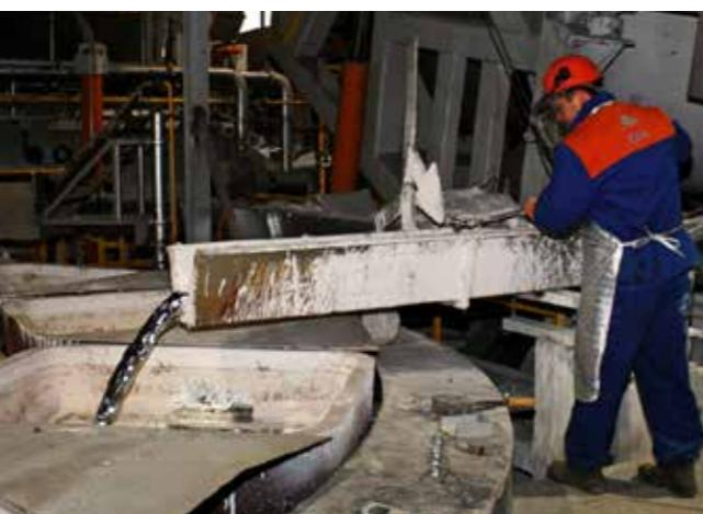
Ispuštanje lijeva iz peći
