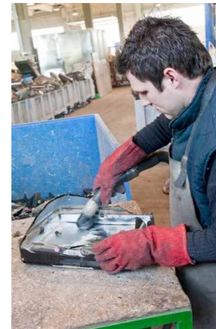
Odstranjivanje fosfora s unutarnje stjenke tv ekrana
