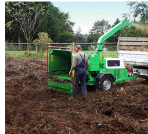
Prije kompostiranja granje se strojno usitnjava – sječkalica
