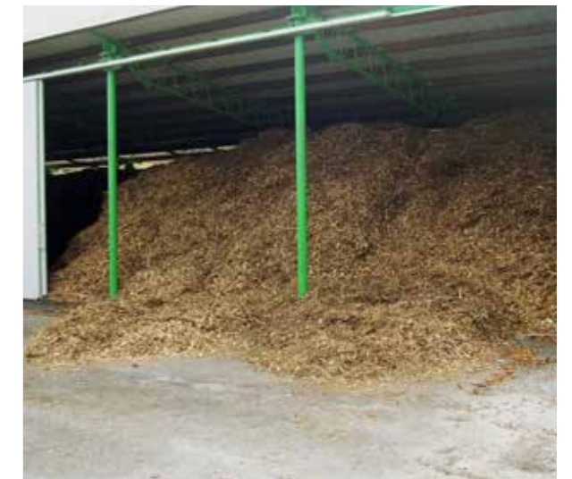
Usitnjeni materijal odlaže se u prozračne prostore radi prirodnog procesa isušivanja
