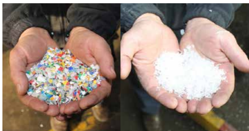
Usitnjavanjem stare plastične ambalaže dobiva se granulat (na slici) čijim topljenjem i ponovnim oblikovanjem dobivamo potpuno nove proizvode.
