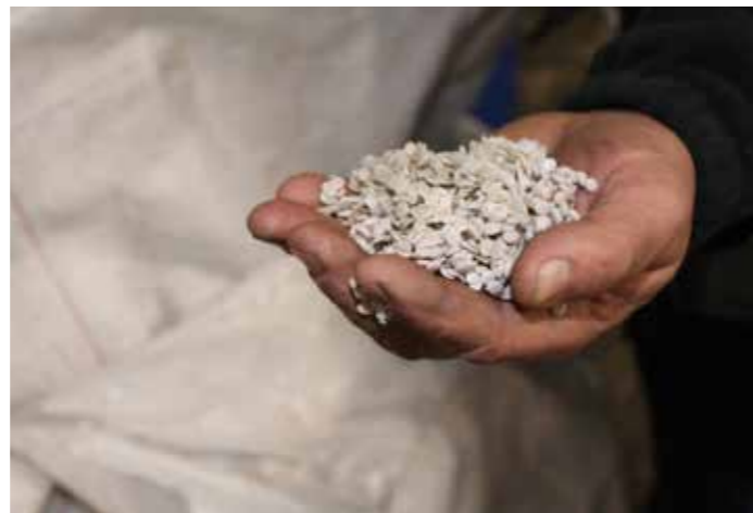
Granulat nastao usitnjavanjem otpadnog polietilena
