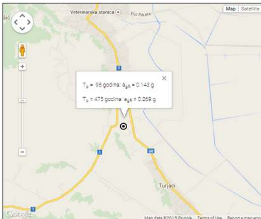
Slika 13. Iznos horizontalnih vršnih ubrzanja tla tipa A ( a_{gR} ) za povratna razdoblja od T_p=95 i 475 godina, izraženih u jedinicama gravitacijskog ubrzanja ( 1\text{ g} = 9.81\text{ m/s}^2 ), za područje zahvata. Izvor: www.seizkarta.gfz.hr (travanj 2015.).
